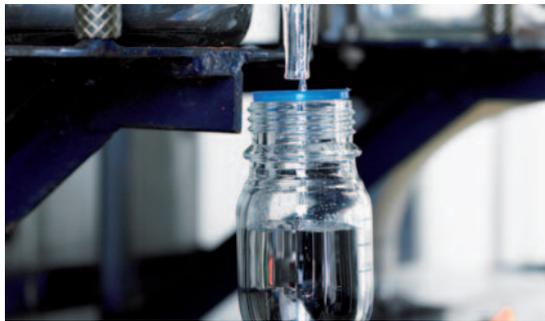
Perfektes Recycling: Das zurückgewonnene Quecksilber zeichnet sich durch einen Reinheitsgrad von bis zu 99,99995 Prozent aus.
