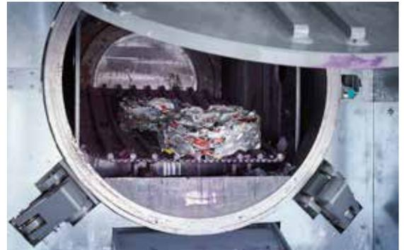
Die von Fremdstoffen befreiten Spraydosen werden bei 300 Bar unter inerten Bedingungen gepresst
