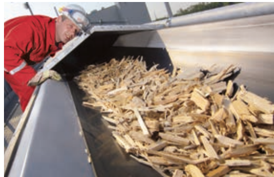
Das in der Holzaufbereitung behandelte Altholz wird im benachbarten Biomassekraftwerk als Brennstoff genutzt
