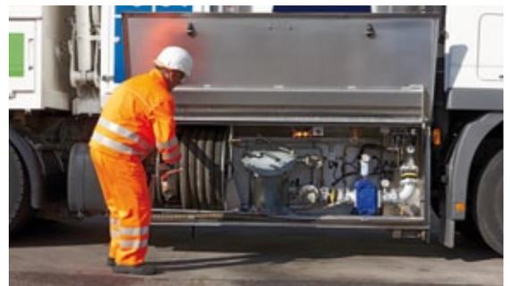
Pumpen und Zuführungsschläuche sind gleich mit an Bord. So können wir flüssige Substanzen absaugen und in den Spezialtanks des Fahrzeugs sicher zum Recycling bringen
