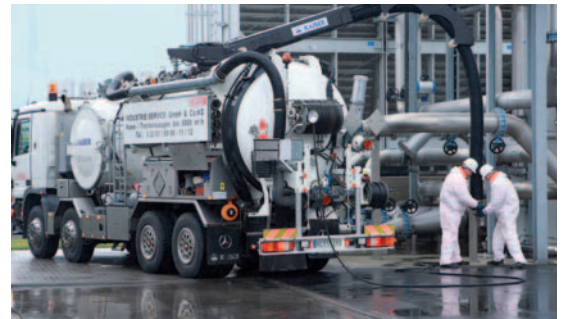
Unser Hochleistungsfahrzeug Hurricane ist Spül- und Saugwagen zugleich. Das heißt für Sie: doppelte Power für optimale Effizienz.
